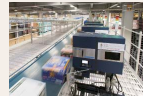
ソーター搬送。エアプッシュ式ラベラーで仕分けラベルを貼り付け
